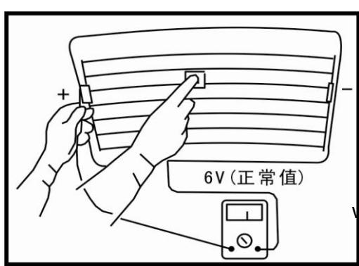
۱) سوئیچ گرم کن شیشه را در وضعیت ON قرارداده و مقدار ولتاژ در وسط سیم گرم کن را با استفاده مولتی متر اندازه گیری کنید.
