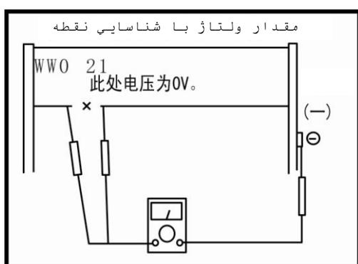
۴) پراپ را به طرف انتهای قطع شده مدار موجود حرکت دهید تا اینکه مقدار قرائت شده روی صفحه مولتی متر افزایش یافته یا به 0V کاهش یابد. نقطه ای که قطع شدن مدار در آن رخ داده بود شناسایی می‌گردد.
