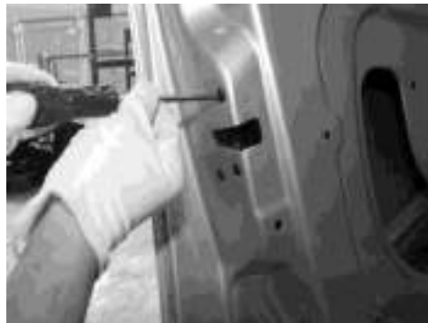
۱۳. پیچ نگهدارنده بدنه قفل در را باز کنید.
