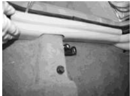
۳) باز کردن صفحات تزئینی رکاب در عقب. به تعویض رکاب در عقب مراجعه نمایید.
