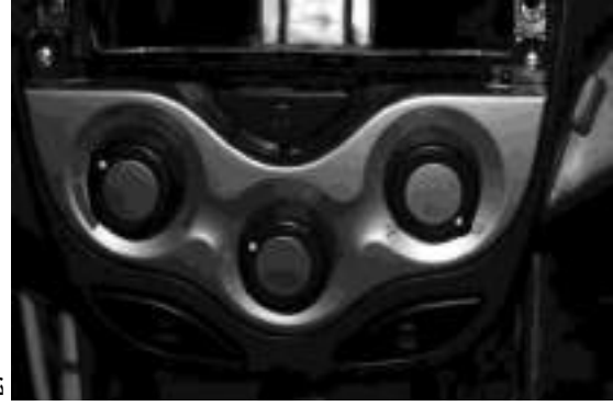
تصویر صفحه کنترل سیستم تهویه
