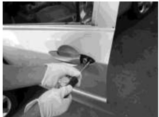
۷. دستگیره خارجی در را باز کرده و پیچ ثابت نگهدارنده را به پایه نصب
